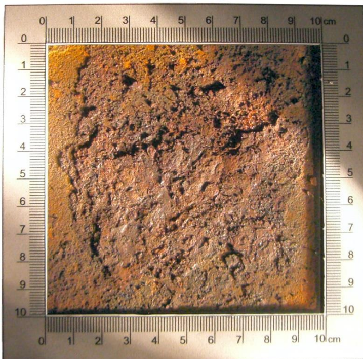
Bild 6: Renhetsgrad: 1.5.x.x Fast rostangrepp i tankens botten
