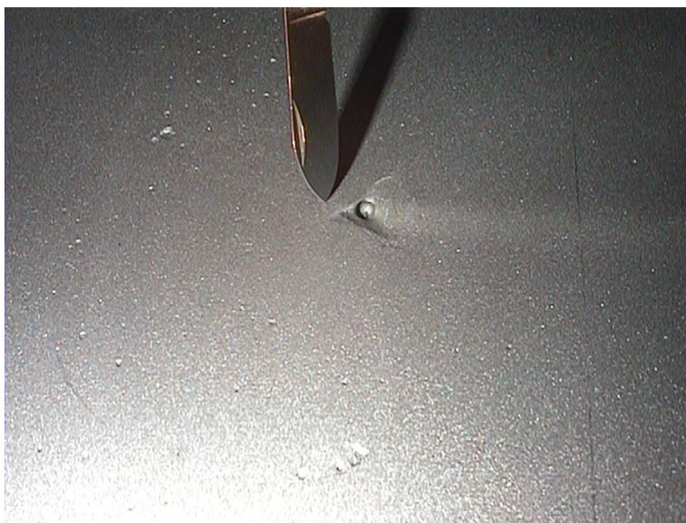
Bild 22: Renhetsgrad 3.6.x.x Hållkorrosion i väggarna
