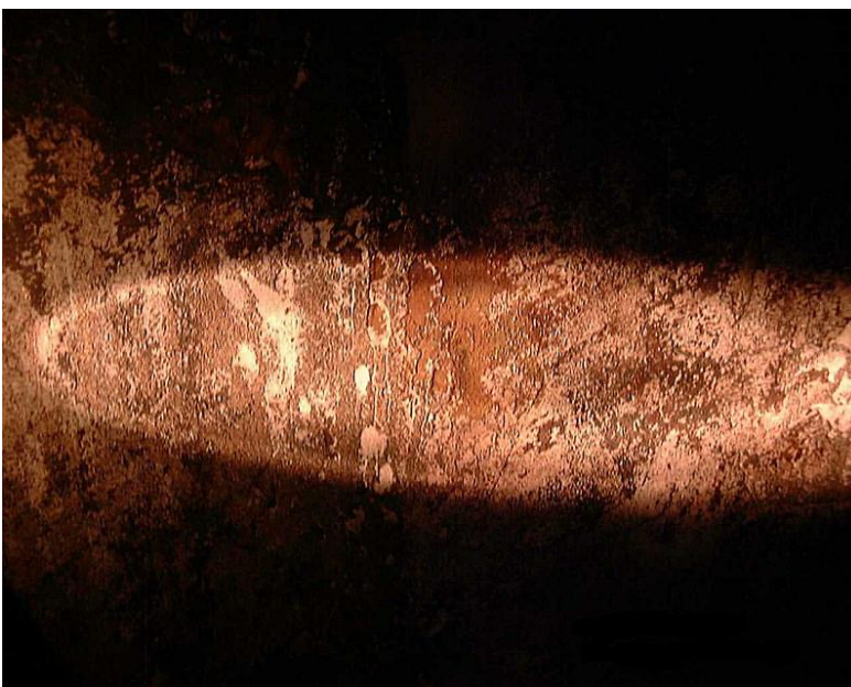
Afbeelding 19: Reinheidsgraad 3.5.x.x Vlakke verruwing met een sterk verkleurd oppervlak
