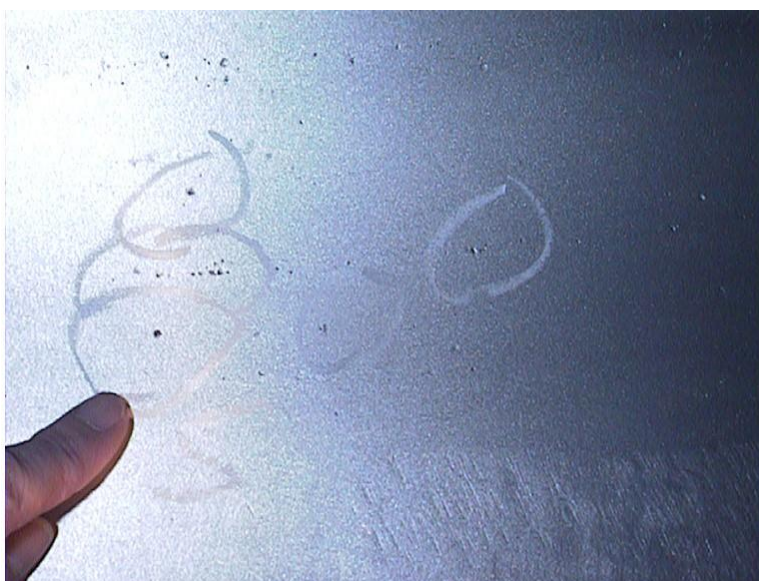
Afbeelding 23: Reinheidsgraad 3.6.x.x Putcorrosie in de wand
