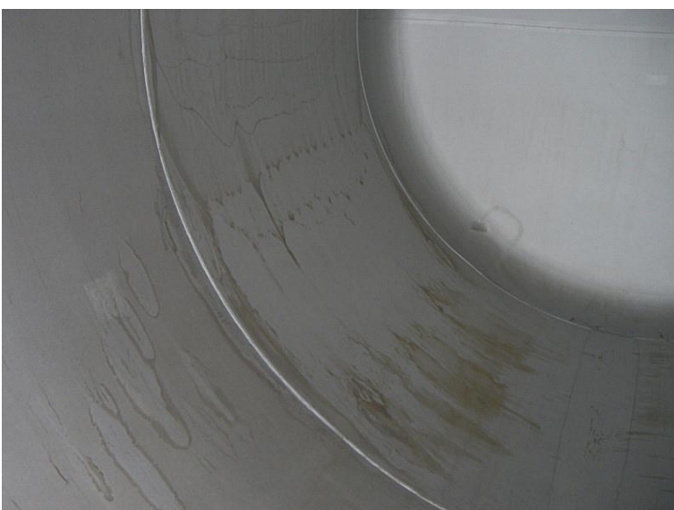
Afbeelding 11: Reinheidsgraad 2.3.x.x Sluierachtige of oppervlakte verkleuring bij een CrNi-staal wagen
