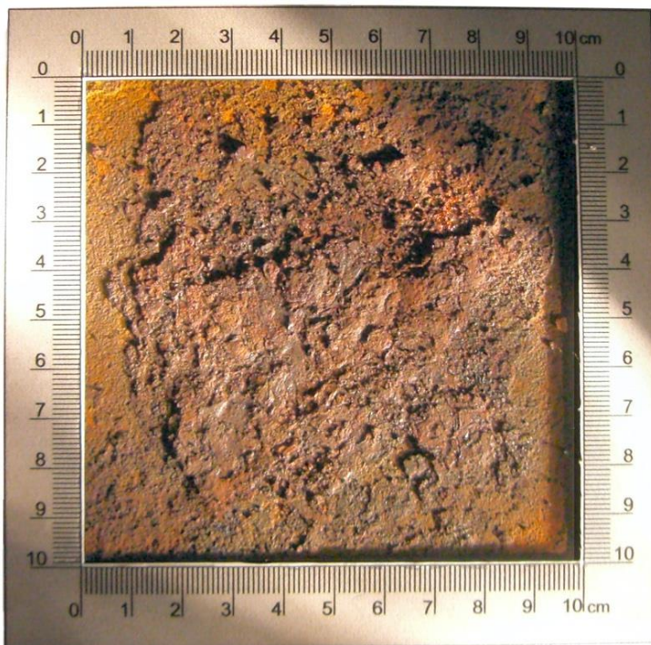
Afbeelding 6: Reinheidsgraad: 1.5.x.x Vaste roest onder in tank
