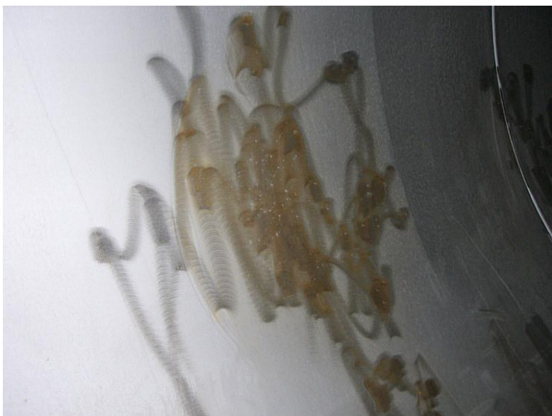
Afbeelding 17: Reinheidsgraad 3.5.x.x Slijpplaatsen met ferritische insluitels
