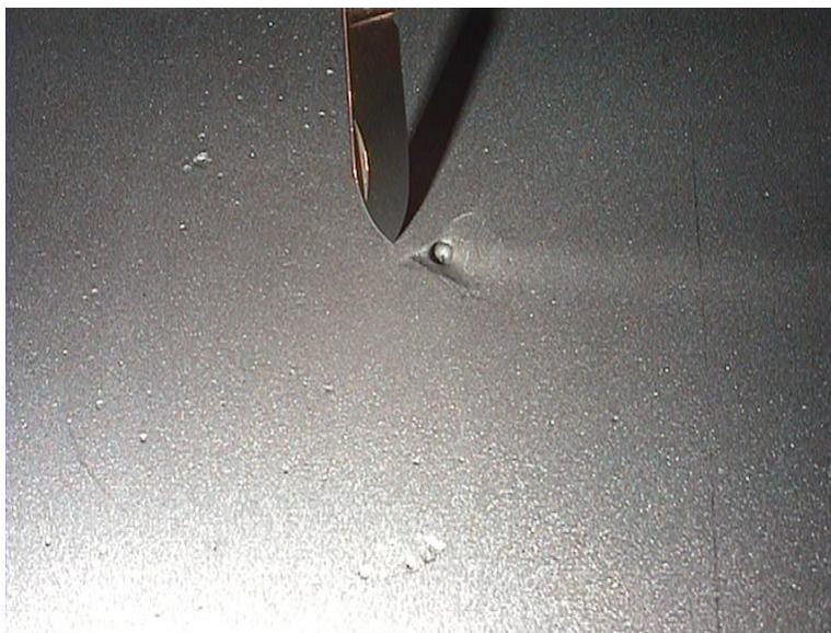
Afbeelding 22: Reinheidsgraad 3.6.x.x Putcorrosie in de wand
