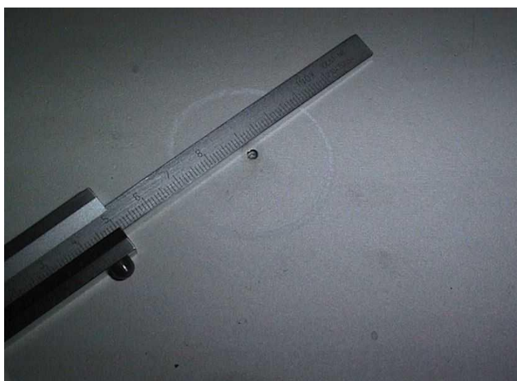
Figura 21: Grado de pureza 3.6.x.x Corrosión por picadura en la pared
