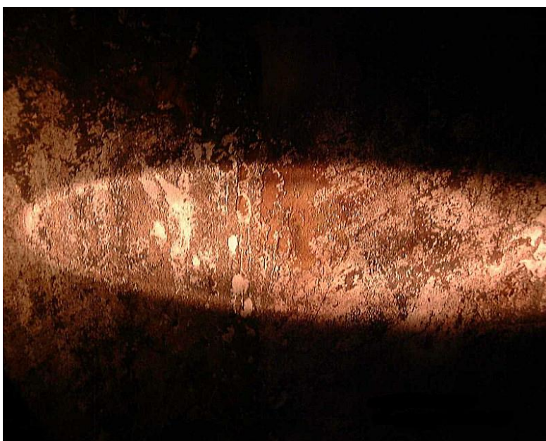
Figura 19: Grado de pureza 3.5.x.x Rugosidades en zonas amplias con una decoloración intensa de la superficie
