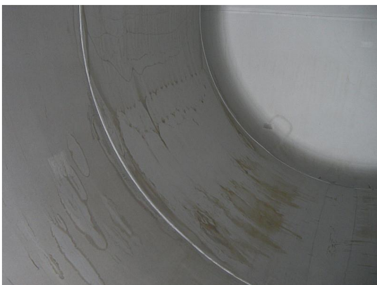
Figura 11: Grado de pureza 2.3.x.x Decoloraciones en forma de veladura o de gran extensión en un vagón cisterna de acero CrNi
