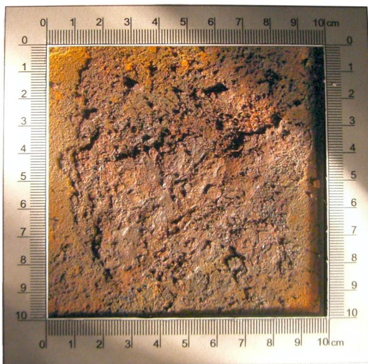
Figura 6: Grado de pureza: 1.5.x.x Óxido compacto en el fondo de la cisterna Siempre que no existan otras limitaciones, se puede restablecer el grado de pureza 1.3.x.x eliminando el óxido compacto.
