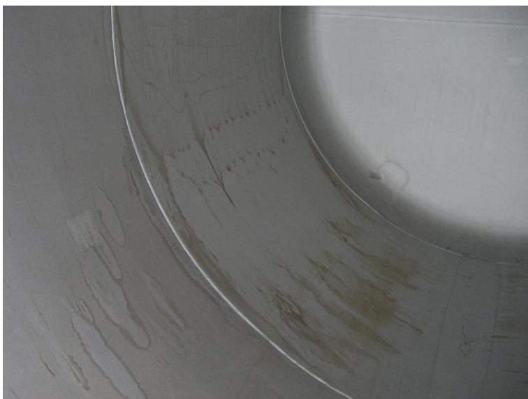
Obrázek 11: Stupeň čistoty 2.3.x.x Závojitě nebo plošné zabarvení u vozu z CrNi- oceli
