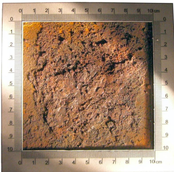
Obrázek 6: Stupeň čistoty: 1.5.x.x Silná rez na dně nádrže
