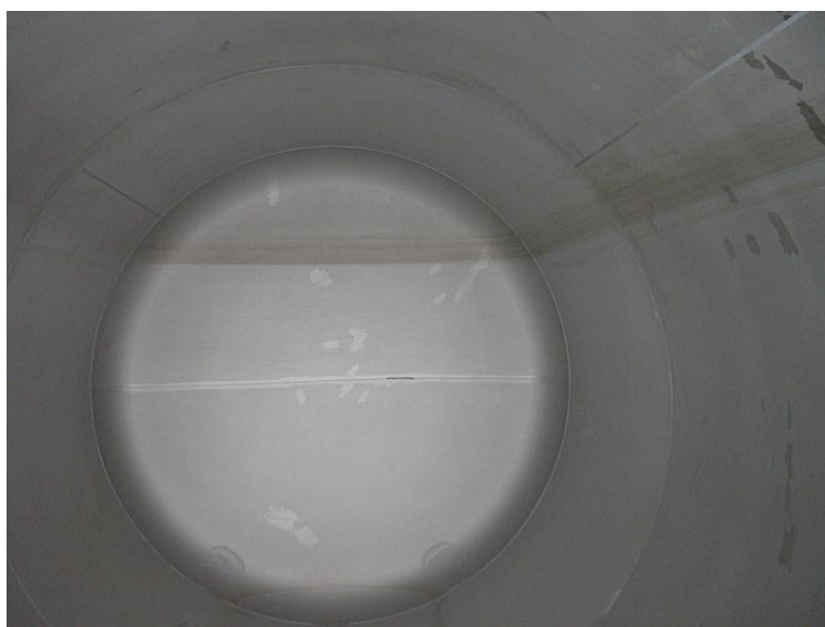
Obrázek 10: Stupeň čistoty 3.3.x.x Obvodové zabarvení „pruhy od ložného zboží“ u vozu z CrNiMo-oceli
